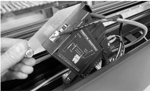
4. Le couvercle du module de commande glisse vers le haut, exposant les (4) piles AA. Remplacez par (4) piles alcalines AA. Nous recommandons une marque connue comme Duracell ou Energizer.
