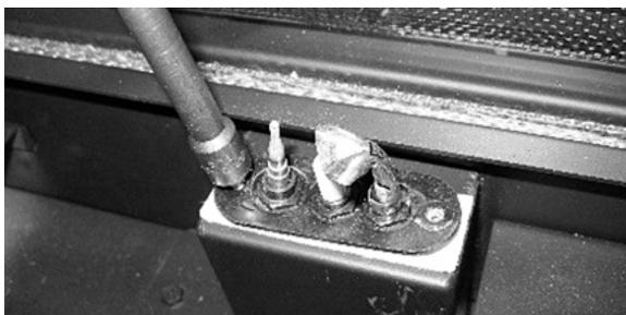
8. Soulevez l'assemblage de la veilleuse dans le foyer qui vous donnera accès aux raccords sous l'assemblage de la veilleuse. Prenez des précautions supplémentaires pour ne pas endommager l'électrode en céramique sur l'assemblage de la veilleuse.
