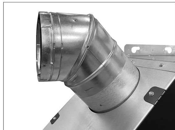
**REMARQUE :** La première pièce de ventilation sur le foyer DOIT être un coude de 45° placé complètement à la verticale ou à l'horizontale.
