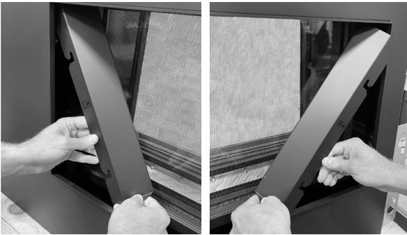
3. L'écran du foyer est maintenu en place par 3 loquets à tension automatique le long de son bord supérieur (4 loquets sur le **SEVENTY2**). Relâchez ces loquets pour retirer l'écran.
