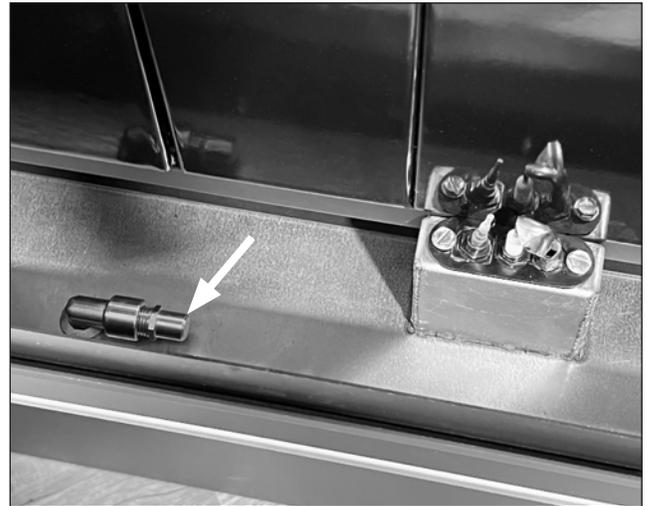
8. Ensuite, convertissez le brûleur au combustible souhaité. Lors de la conversion au propane, retirez le collier sur le tube d'entrée du brûleur. Lors de la conversion au gaz naturel, installez le collier sur le tube d'entrée du brûleur et fixez-le avec une vis à tôle #8 fournie à l'aide d'un 1/4" un fou du volant.
