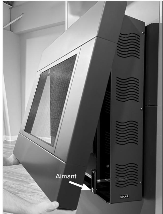
7. Pour retirer le façade avec écran intégré, tirez le bord inférieur du façade vers l'extérieur pour désengager les aimants, puis soulevez le haut et retirez-le des supports supérieurs.
