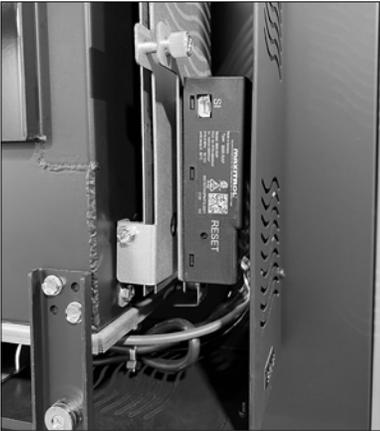
3. Faites glisser l'assemblage du module de commande vers le haut et vers le à gauche comme indiqué.
