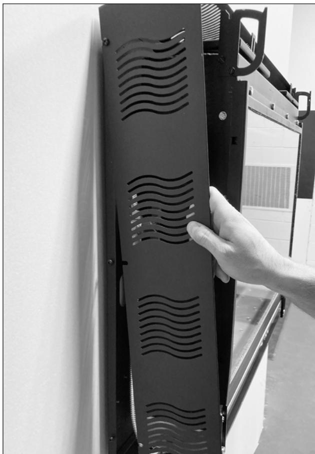
3. Localisez le trou de fixation sur le bord avant supérieur du panneau latéral extérieur gauche et alignez-le avec l'écrou PEM à l'avant du panneau supérieur. Insérez la vis cruciforme.
