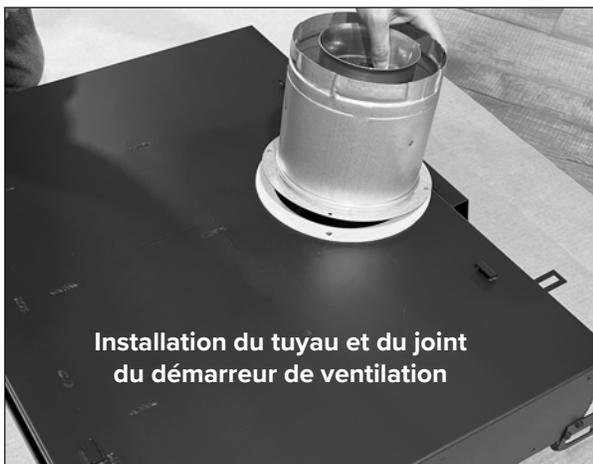
18. Lorsque la bride entre en contact avec le joint, installez les (4) fixations #10, 5/16" fournies avec le tuyau de démarrage.
