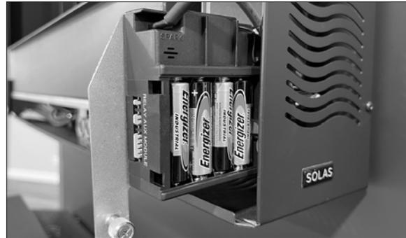
5. Remplacez le couvercle des piles, faites glisser le module de commande dans le foyer et serrez la vis à oreilles argentée.
