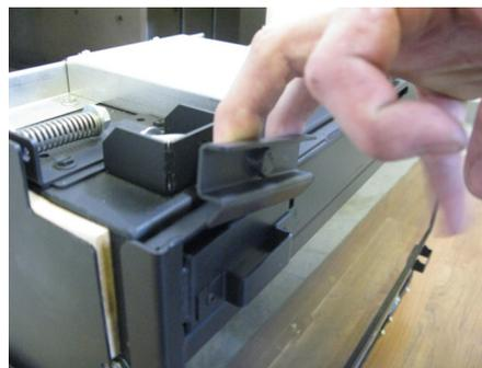
Une fois que les quatre attaches ont été libérées, le cadre de la vitre peut basculer vers l'avant et être soulevé de la rainure de maintien. La vitre est fixée à son cadre par des boulons de maintien, donc enlever l'ensemble. Placer votre pouce sur l'extérieur du cadre, en plaçant vos doigts autour du cadre et de la vitre. Maintenir fermement le cadre et la vitre lorsque vous la déplacez. Avec précaution enlever le cadre et la vitre du foyer. Les mettre de côté sur une surface souple.
