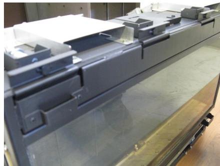
Tirer vers l'avant chacune de ces attaches en les faisant pivoter de 180 degrés en même temps.
